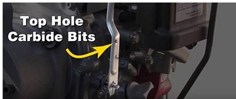
Notez bien que la perceuse RB35 fonctionne à 350 tr/min lors de l'utilisation optimale des embouts torsadés au carbure. Le modèle RB28 fonctionne à un régime de 150 tr/min lorsqu'il est utilisé avec les embouts torsadés noirs. Cependant, vous pouvez ajuster le ressort d'étranglement de votre perceuse pour permettre un rendement à 230 tr/min.
